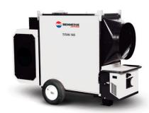
**TITAN:** крупногабаритные нагреватели непрямого нагрева. Идеальны для применения в больших зданиях. Их особенность - выносная горелка на выбор: газовая (СПБ или на газе метан) и дизельная. Оснащены центробежным вентилятором, что гарантирует низкий уровень шума, а так же высокое статическое давление (500 Па), которое позволяет применять длинные шланги. Особенность камеры сгорания: наличие 5-ти дымовых кругов, благодаря чему достигается КПД 96%.
