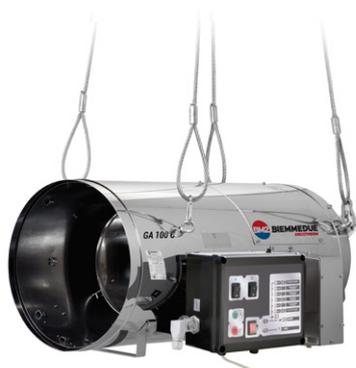
**GA:** корпус из нержавеющей стали для защиты от коррозии типичной для ангаров, работают на газе пропан-бутан, встроенная горелка, прямой нагрев, высокого давления (1.5 бар). Оснащены функцией автоматического старта благодаря прямому соединению блока управления с термостатом контроля старта и остановки. Это самые экономичные нагреватели для применения в теплицах и ангарах.
