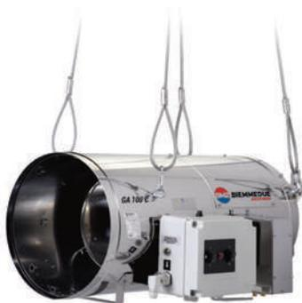
**GA:** корпус из нержавеющей стали для защиты от коррозии типичной для ангаров, работают на газе пропан-бутан, встроенная горелка, прямой нагрев, высокого давления (1.5 бар). Оснащены функцией автоматического старта благодаря прямому соединению блока управления с термостатом контроля старта и остановки. Это самые экономичные нагреватели для применения в теплицах и ангарах.
