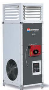
**SP:** дизельные, на газе пропан-бутан или метан, с выносной горелкой. Модели комплектуются центробежным вентилятором и применяются при необходимости обработки большого объема воздуха и/или при обогреве больших площадей. Благодаря наличию различных аксессуаров, они свободно приспособляются к различным условиям. Могут быть как канальные, так и неканальные.
