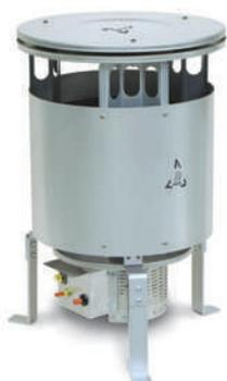
**GW:** питание от газа пропан-бутан (1,5 бар) высокого давления, со встроенной горелкой, применяется принцип прямого нагрева. Автономные, не требуют питания от электрической сети, механический пьезоэлектрический поджиг. Требуется только подключение к газовому баллону. Экономичны и просты в обращении.
