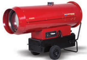
**ЕС и PHOEN:** дизельные нагреватели воздуха со встроенной горелкой (ЕС) и с отдельной горелкой (PHOEN). Применяется непрямой нагрев, при котором тепло-обменник отводит отработанные газы наружу через дымоход. Благодаря этому, возможно их применение в закрытых помещениях. Однако, при высокой стоимости их КПД около 90 % из-за потери тепла через дымоход.
