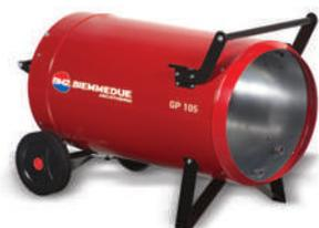
**GP:** нагреватели высокого давления (1.5 бар) прямого нагрева на газе пропан-бутан со встроенной горелкой. Представлены 2 вида: с ручным, пьезоэлектрическим поджигом (М) и с автоматическим поджигом (А), с возможностью подключения комнатного термостата, который регулирует запуск и остановку нагревателя. Обычно подключаются к бытовому газовому баллону, что делает работу очень экономичной и простой.
