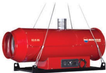
**EC/S и PHOEN/S:** корпус из окрашенной стали, дизельные, встроенная (EC) и выносная (PHOEN) горелки, не прямой нагрев. Нагреватели оснащены теплообменником, который отводит отработанные газы наружу через дымоход. Благодаря этому возможно их применение в закрытых помещениях. Однако, их стоимость более высокая, а КПД около 90 % из-за потери тепла через дымоход.
