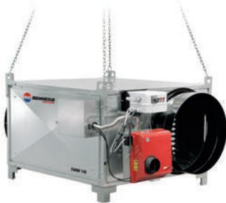
**FARM:** из оцинкованной стали, непрямого нагрева. Мощные нагреватели предназначены для помещений большой площади. Может устанавливаться выносная дизельная, газовая горелка (газ пропан-бутан и метан). Могут поставляться с центробежным вентилятором, который, работая тихо, увеличивает давление, необходимое в случае применения гибкого шланга или работы в больших зданиях.
