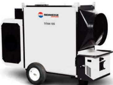
**TITAN:** крупногабаритные нагреватели непрямого нагрева. Идеальны для применения в больших зданиях. Их особенность - выносная горелка на выбор: газовая (СПБ или на газе метан) и дизельная. Оснащены центробежным вентилятором, что гарантирует низкий уровень шума, а так же высокое статическое давление (500 Па), которое позволяет применять длинные шланги. Особенность камеры сгорания: наличие 5-ти дымовых кругов, благодаря чему достигается КПД 96%.
