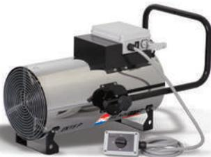
**EK P:** работают от электричества. Вместо горелки присутствуют электрические тэны, которые нагревают воздух подаваемый вентилятором. Эти характеристики делают возможным их применение в любых условиях, даже в закрытых помещениях. Однако, из-за ограниченной тепловой мощности, их применяют, если имеется возможность использовать дешевую электроэнергию и в небольших помещениях.
