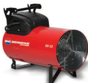
**EK:** имеют похожую на модели GP конструкцию, но работают от электричества. Вместо горелки присутствуют электрические тэны, которые нагревают воздух, подаваемый вентилятором. Эти характеристики делают электрические нагреватели удобными в любых условиях, даже в закрытых помещениях. Однако, у них ограниченная тепловая мощность и их применяют, если имеется возможность использовать дешевую электроэнергию.
